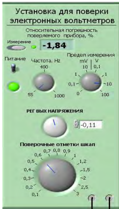
Рисунок 8.5 Загальний вигляд установки В 1-4
