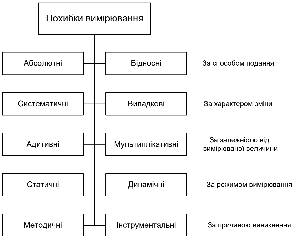
Рис. 1.9. Класифікація похибок вимірювання.
