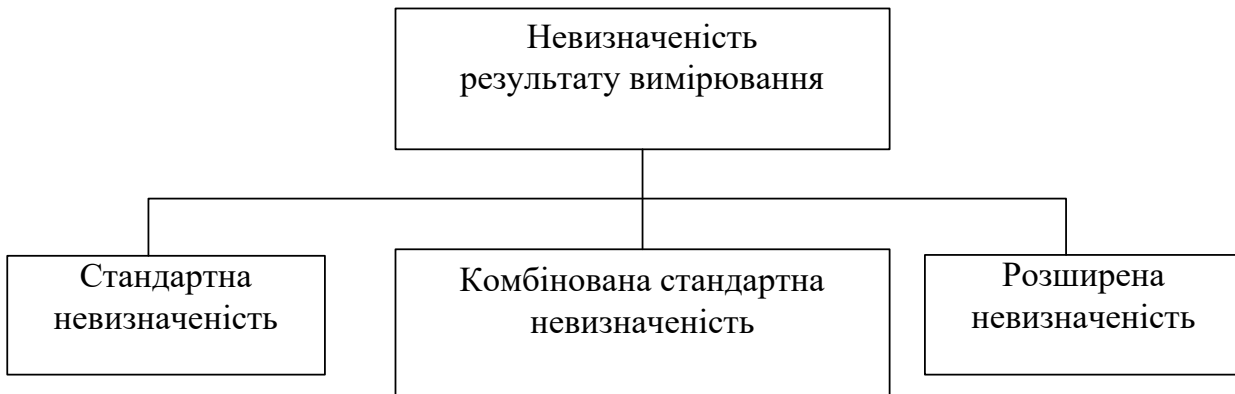
Рисунок 5.2 — Форми подання невизначеності результату вимірювання.
